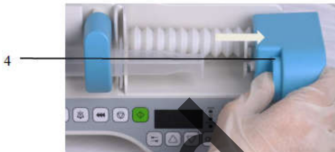
Figura 5-6 Deschidere cleme tija de împingere
