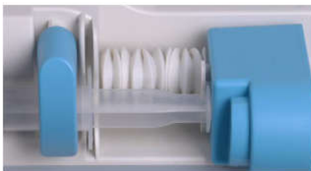
Figura 5-8 Securizare margine piston seringă
